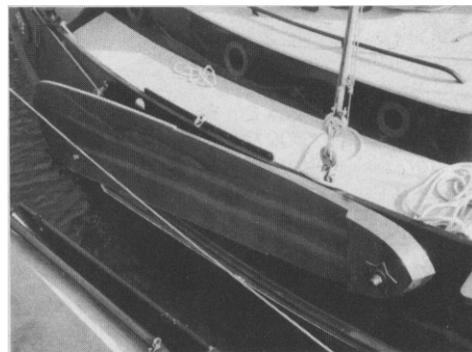
*Wie ein Flugzeugflügel profiliert sind die schmalen, aus Eichenholz gefertigten Seitenschwerver.*
